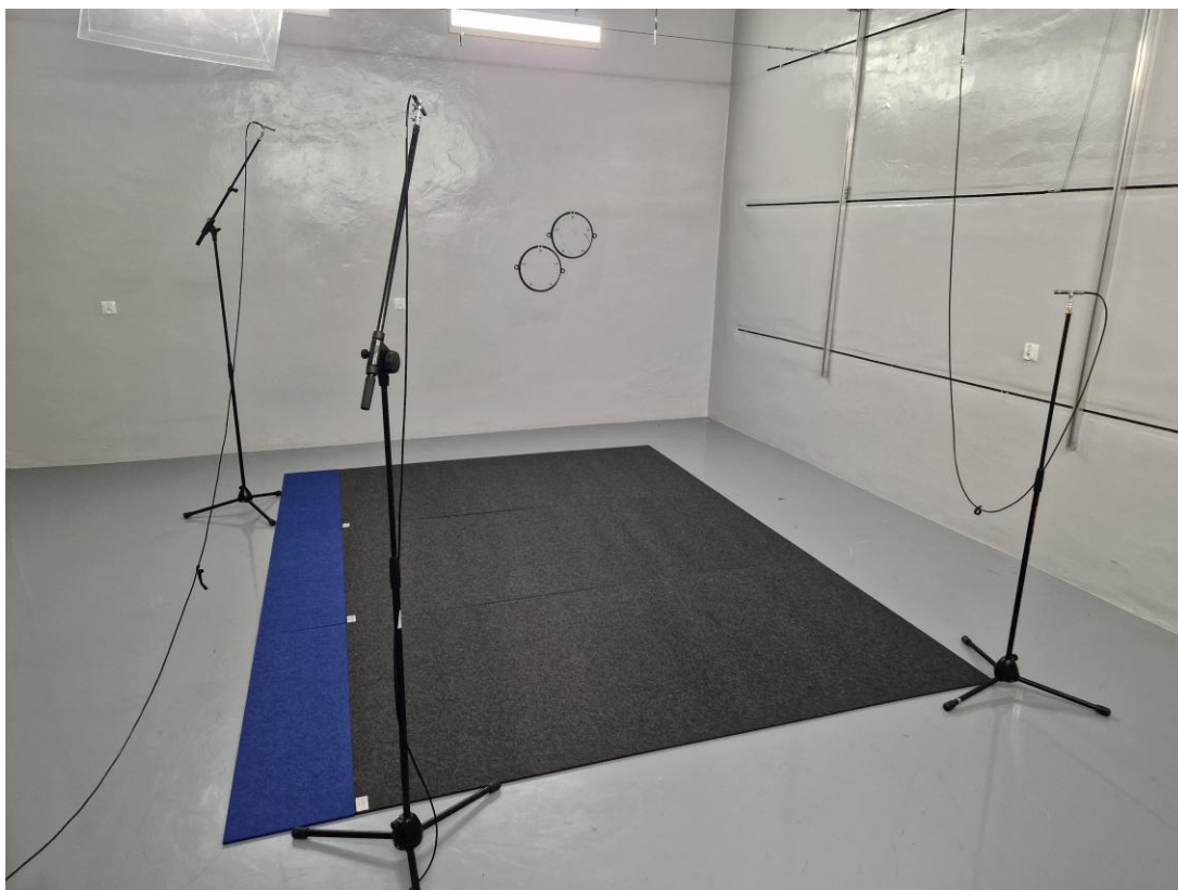
Rysunek 1 Sposób zamontowania próbki nr 1 w komorze pogłosowej.
