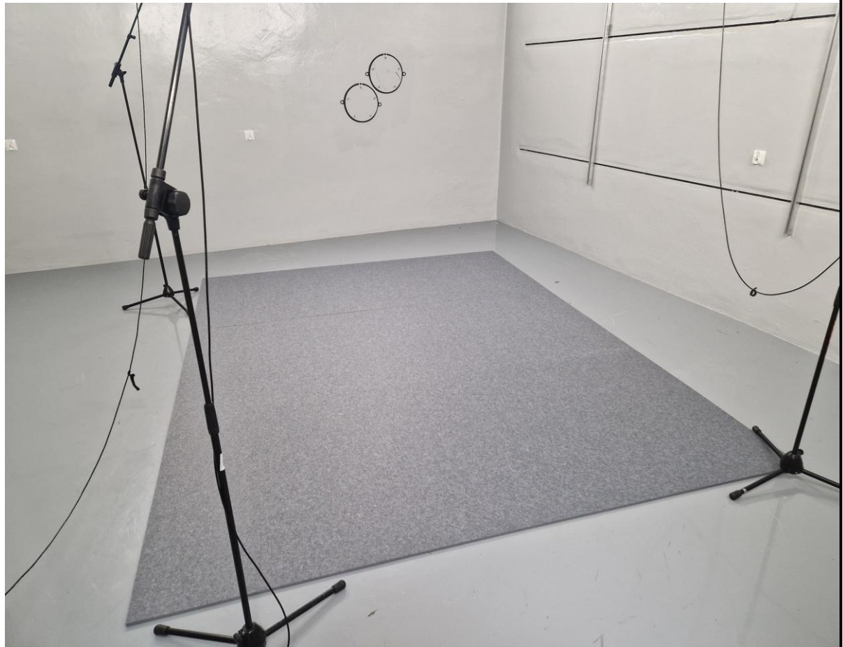
Rysunek 2 Sposób zamontowania próbki nr 2 w komorze pogłosowej.
